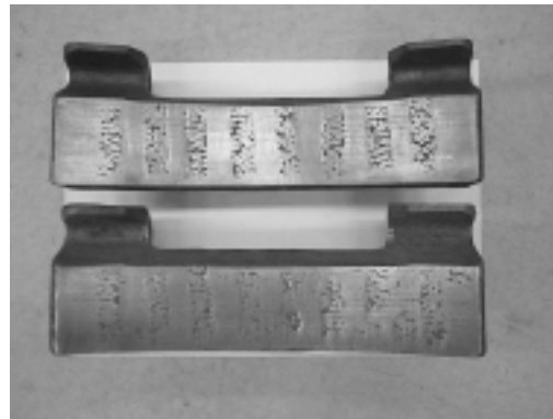
図4 試作制輪子(SiC/YHC3型)
