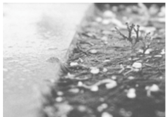
図 3 CCGFC に付着成長する褐藻
