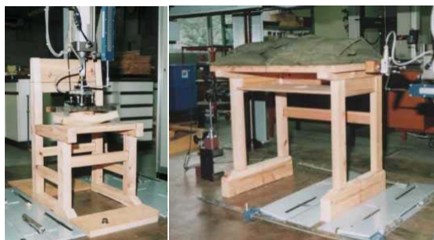
開発した机・いすの強度試験 (JIS S 1021)
