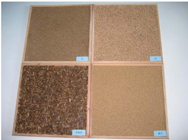
面塗り材の試作(上段)杉、栓、(下段)樹皮、真竹
