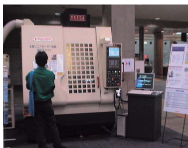
写真2 出店された金型用CCM加工 システム試作機
