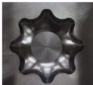
写真3 花卉型金型 (仕上げ加工後)
