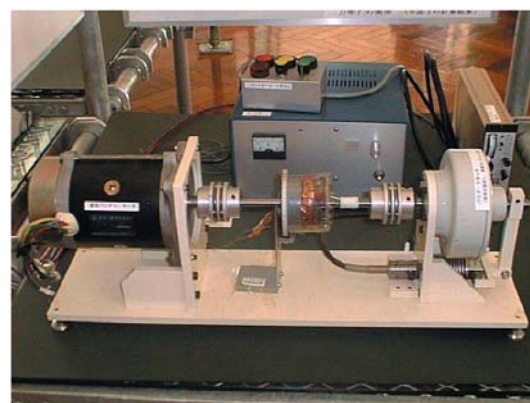
図6 動力計への応用（中央の検出器へ給電）
