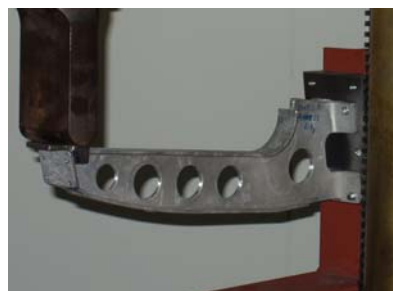
図4 荷棚受けの実体強度試験の様子
