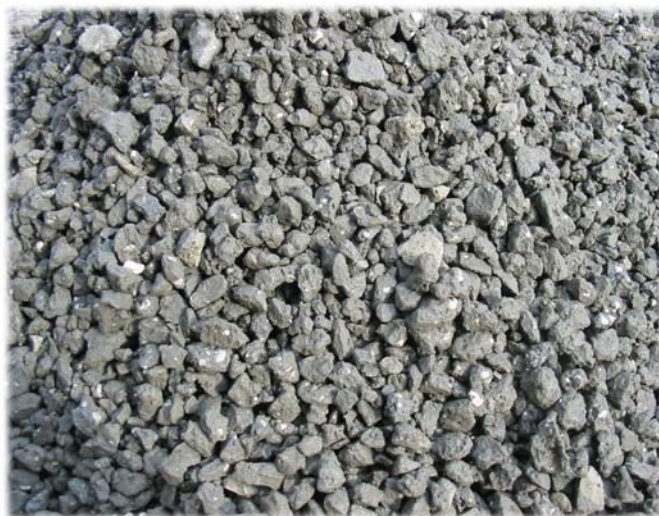
再生クラッシャーラン RRC-40(平成 20 年 3 月大分県リサイクル製品認定)
