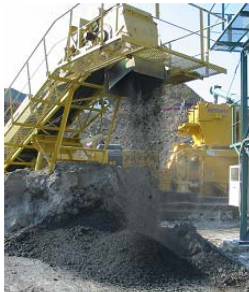
図2 再生クラッシャーラン RRC-40 の製造状況
