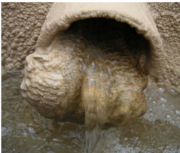
図 3 パイプへのスケール付着の例(山香温泉)
