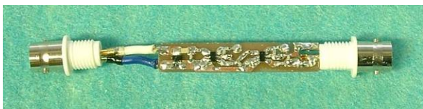
図 5 試作した 33dB 受信アンプ
