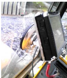
図 4 吸盤を用いた PC アタッチメント
