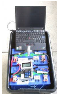
図 5 カーバッテリーを 用いた給電試験装置
