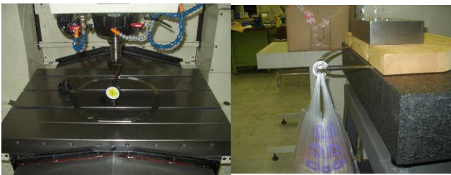
写真 2 平坦度・耐荷重性評価
