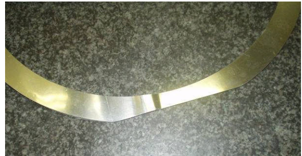
写真 4 残留歪の生じたサンドイッチ形構造リング
