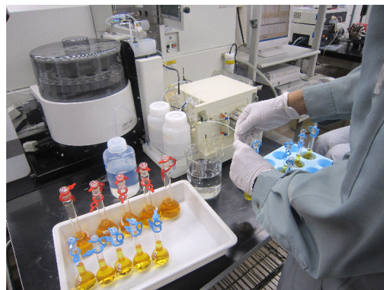
水素化物発生法の前処理条件検討（原子吸光分析）
