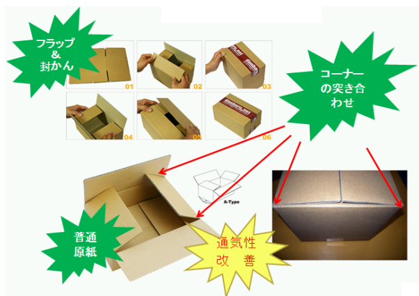
図3 段ボール容器の通気ポイント
