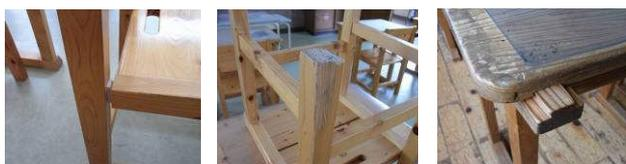
ほぞの抜け 材の欠け あり棧のずれ
