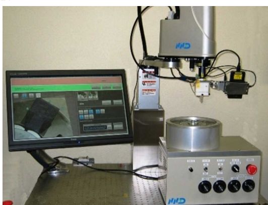
図2 ベクトル磁気特性可視化装置(西日本電線(株))
