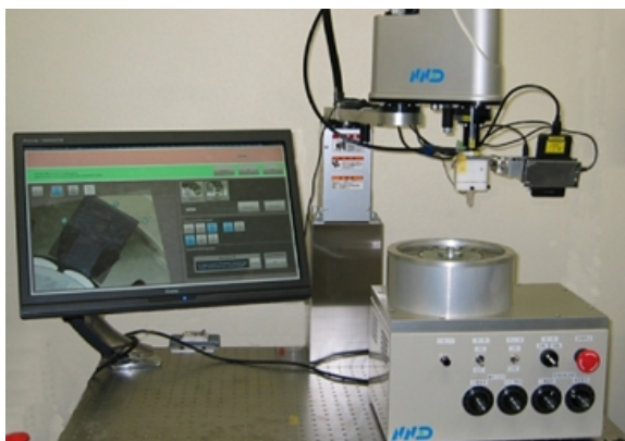
図 1 ベクトル磁気特性可視化装置
