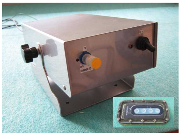
写真4 無線リモコン装置（本体）と送信機 のプロトタイプ
