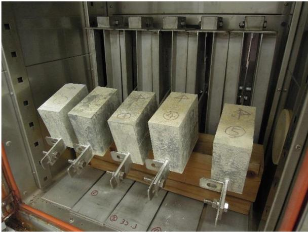
写真.2 デッドロードストレス試験
