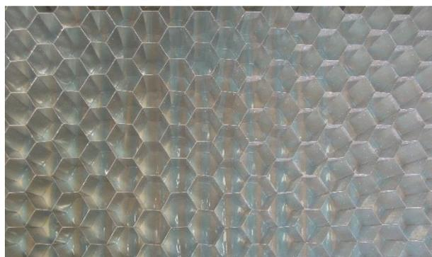
写真.1 アルミニウム合金接着ハニカムパネル
