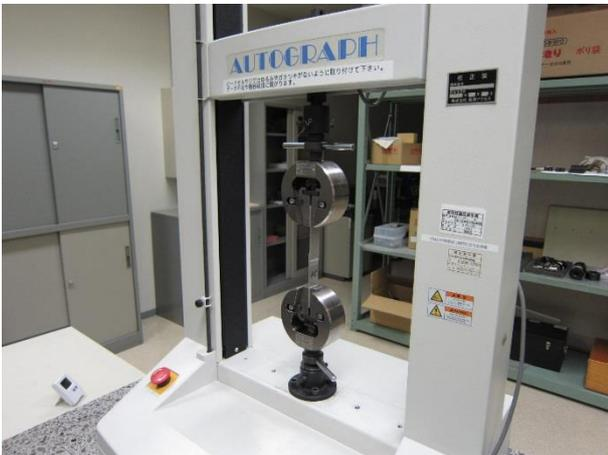
写真.3 引張せん断強度試験
