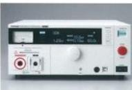
耐電圧・絶縁抵抗試験器
