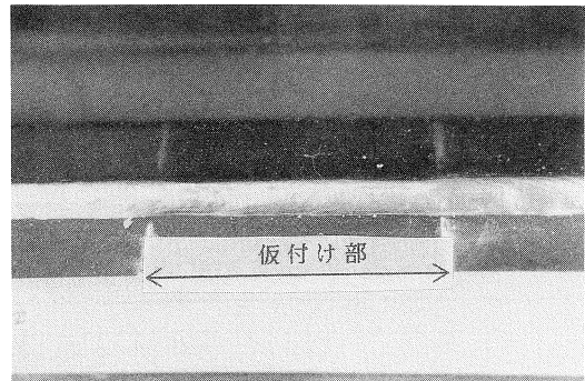
写真3 フラックス入りワイヤによるすみ肉溶接例
