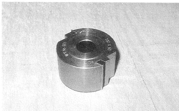
写真-6 ブロック組み合わせ型カッター
