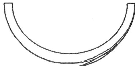
図-15 破壊した曲げ木部材
