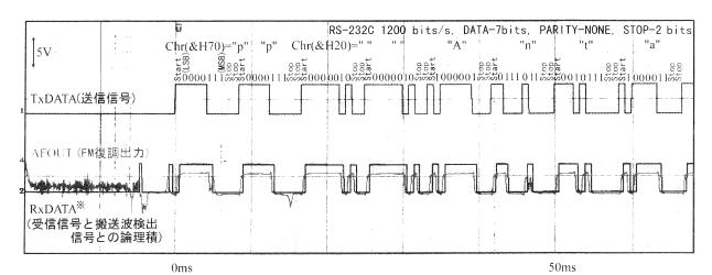
Fig. 5 無線データ通信の送受信波形とその説明
