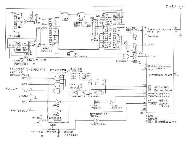
Fig. 2 無線データ通信インターフェース回路図
