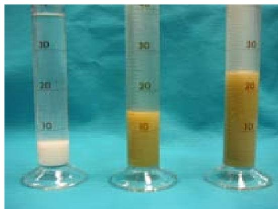
写真1 ペースト素材の水中での膨潤状態 (左から、市販セルロース素材、無処理、素材化処理)
