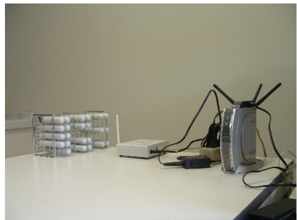
Fig.2 無線温度センサの通信実験
