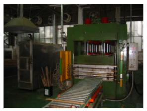
Fig.2 1,000トンのプレスができる圧密加工装置
