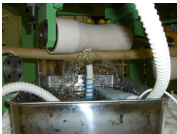
Fig.4 冷却による固定化の様子
