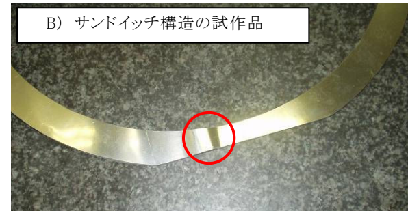
Fig.3 塑性歪の生じた試作品
