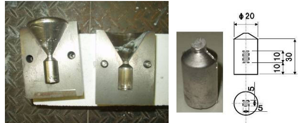
Fig.3 水素ガス分析試験片用金型 (左) と水素ガス分析試験片の採取位置 (右: 斜線部を採取)
