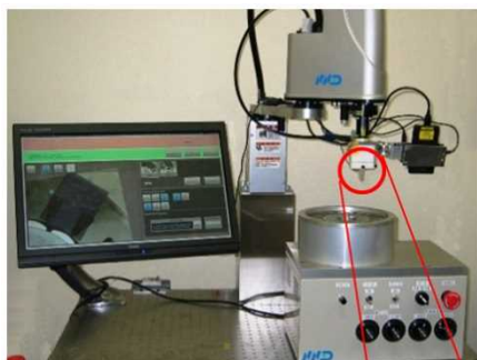
ベクトル磁気特性可視化装置
