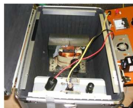
電撃装置の内部写真
