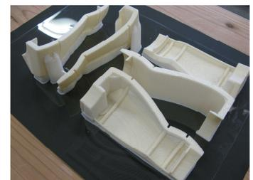
【図4】 3Dプリンタ製竹編み治具の試作
