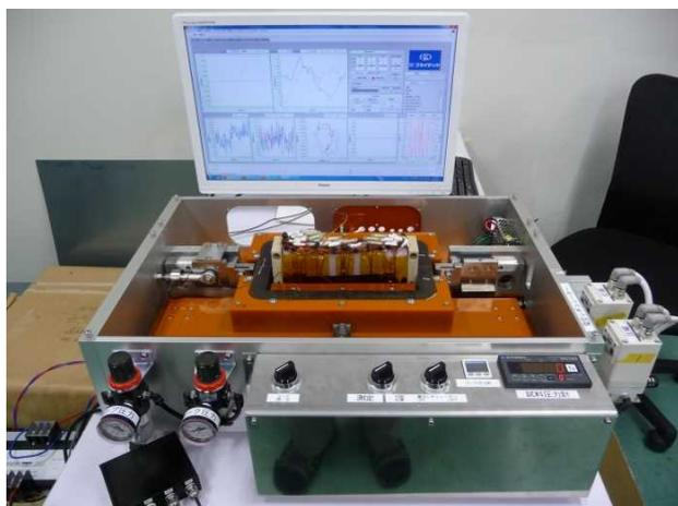
図 1 応力負荷型単板磁気試験器
