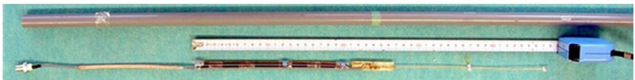
図 1 考案した線条アンテナの概略図(上) 及び 中心周波数 315MHz 試作品 写真(下)
