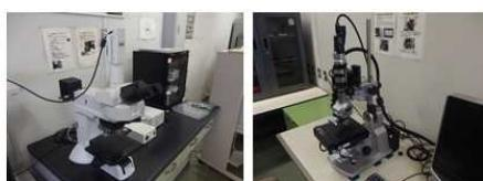
金属顕微鏡試験用機器
