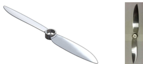
図1 プロペラ形状の設計案と完成品(右:直径=400mm)
