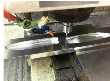
図4 マシニングセンタによる切削加工状況
