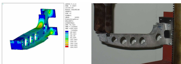
図 3. 荷棚受けの応力解析(左)と製品強度試験(右)
