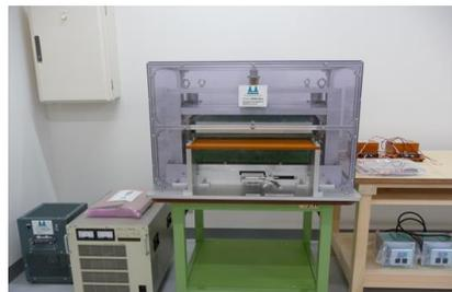
IEC 準拠単板試験器(電磁鋼板評価)
