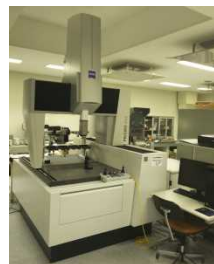
三次元測定機独カールツァイス社製「PRISMO ultra」
