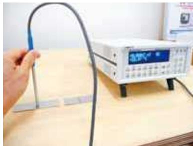
依頼試験：SUSの残留磁化測定
