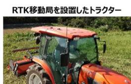
RTK移動局を設置したトラクター
