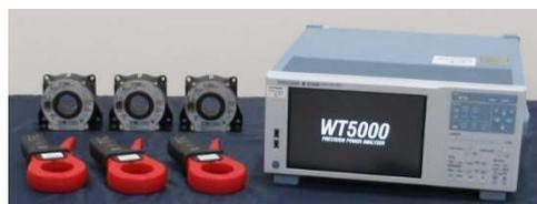
導入したパワーアナライザ(横河計測製 WT5000)
