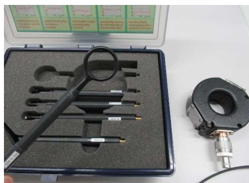
図2 左：近磁界プローブ、右：RF 電流プローブ
