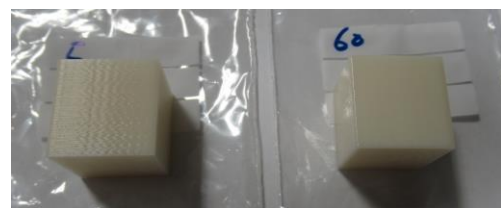
Fig. 11 アセトン処理表面の 5 分 (左) 60 分 (右)
