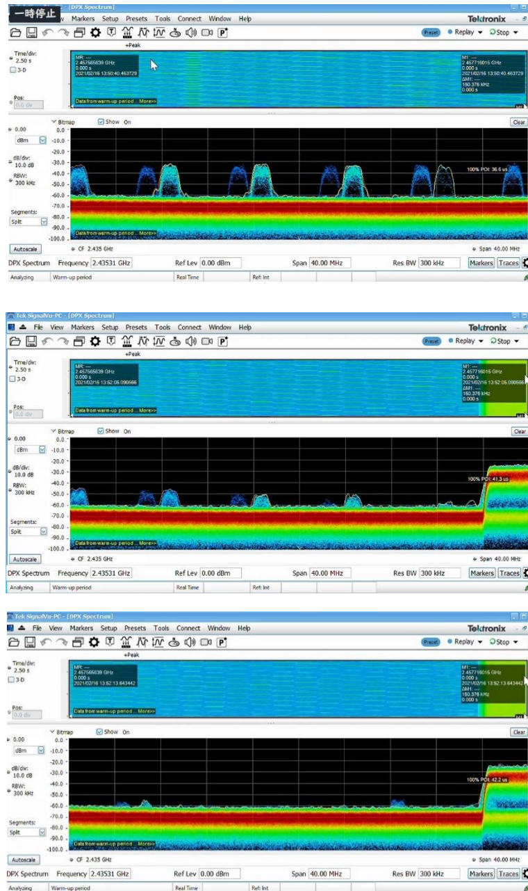
Fig. 6 インバウンド領域でのスペクトル例(高高度になるほど上り信号が減衰)
