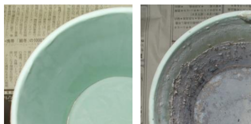
Fig.4 耐熱皮膜の剥離(左:実験前, 右:実験後)
