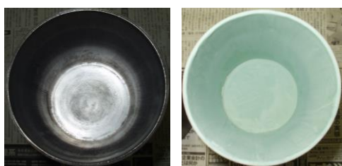
Fig.1 耐熱皮膜のコーティング (左:コーティング前, 右:コーティング後)
