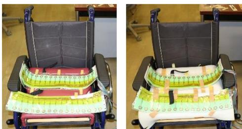
Fig.3 体圧分布測定(左:試作品A, 右:試作品B)
