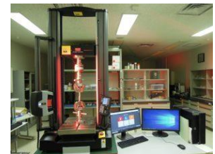
静荷重試験機 ＜曲げ・引張強度測定＞
